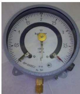
Рисунок 1 - Общий вид манометров, вакуумметров, мановакуумметров сигнализирующих ДМ2005Сг, ДВ2005Сг, ДА2005Сг
