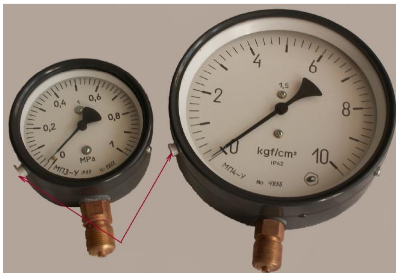
Рис. 4. Места пломбировки приборов
