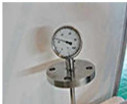
Гильза защитная ГЗ-ТБ (для термометров биметаллических); ГЗ-ТМ (для термометров манометрических) предназначена для защиты термобаллонов от высокого давления, химического и механического воздействия измеряемых сред, а также для того, чтобы замена термометра не повлекла нежелательную остановку агрегата.
