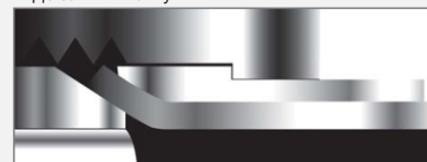
После затяжки гайки
