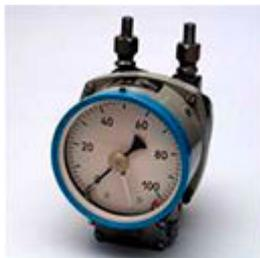
Дифференциальные манометры (дифманометры) сильфонные предназначены для измерения: расхода жидких и газообразных сред по методу переменного перепада давлений (расходомеры); разности давлений жидких и газообразных сред (перепадомеры); уровня жидких сред, находящихся под атмосферным, вакуумметрическим или избыточным давлением (уровнемеры).
