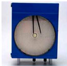
Предназначены для измерения и записи на дисковой диаграмме избыточного и вакуумметрического давления жидких и газообразных неагрессивных сред.
