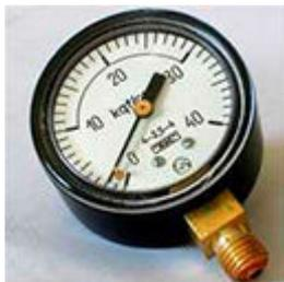
Предназначены для измерения избыточного и вакуумметрического давления неагрессивных некристаллизующихся жидкостей и газов, в том числе кислорода, водорода, ацетилена, и применяются для контроля технологических процессов в различных отраслях промышленности.
