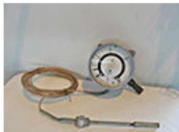
Термометры манометрические показывающие сигнализирующие предназначены для измерения температуры жидких и газообразных сред в стационарных промышленных установках и управления внешними электрическими цепями от сигнализирующего устройства.
