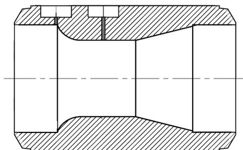
Рисунок 1.17 - Конструкция сопла Вентури
