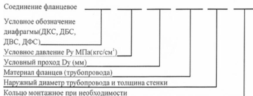
При заказе соединения фланцевого для диафрагмы:
